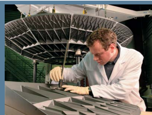
Fertigung von Weltraumteleskopen aus Boostec SiC
