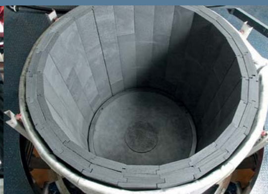
CALCARB®-Isolierzylinder in Segmentbauweise
